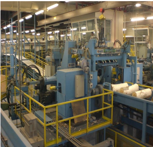
Figure II.23- Ligne de déroulage.
