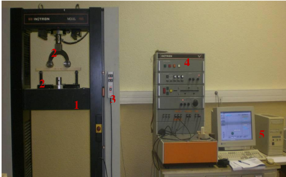
Figure II.38 - Machine utilisée pour la flexion statique INSTRON 1185.
